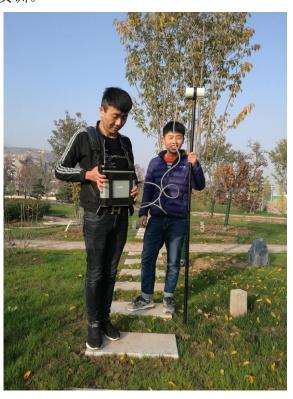
③下图为高密度电法测量布置图,钢板布设完成后,尚无种草。
